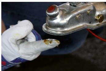
Bild: Kugelschale fetten
