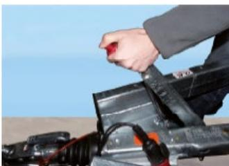
Bild 7: Feststellbremse lösen
