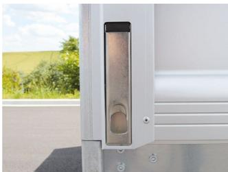
Bild: versenkte Verschlüsse
