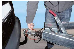
Bild 2: Kugelkupplung positionieren
