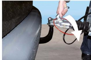
Bild 4: Kugelkupplung schließen
