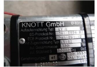
Bild: KNOTT Auflaufeinrichtung
