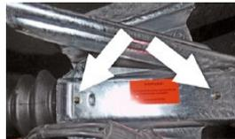
Bild: Schmiernippel Aufaufeinrichtung
