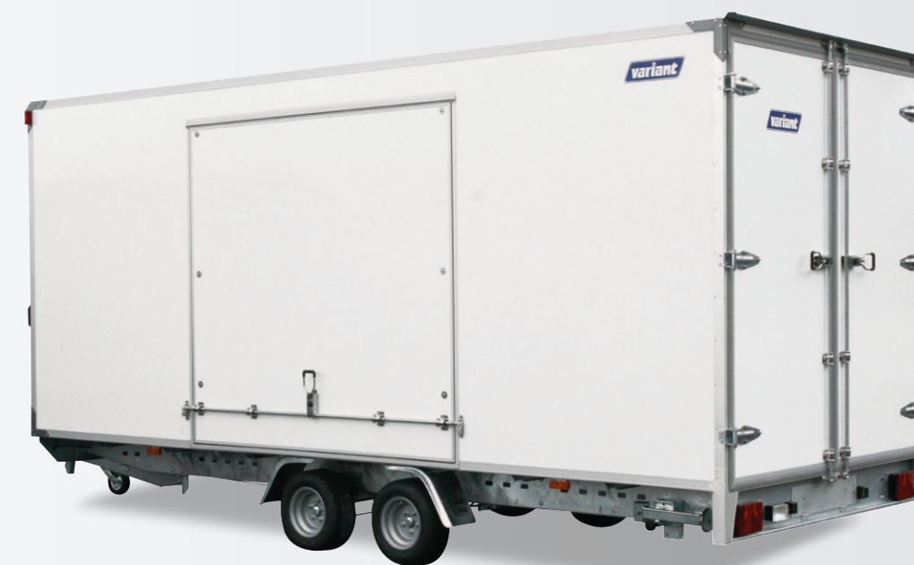
SEITENTÜR Drehstangenverschluss sorgt für dichten Verschluss.
