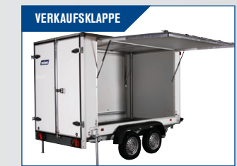
VERKAUFSKLAPPE Große Öffnung in der Seite mit sturmsicheren Stoßdämpfern.
