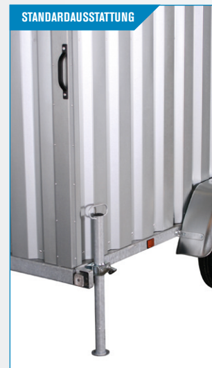
4 Stützbeine und Haltegriffe sorgen für Stabilität und leichtes Rangieren.
