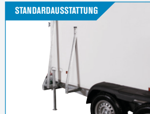
STANDARDAUSSTATTUNG Stützbeine, Seitenverstärkung und Stützrad ist alles standardmäßig montiert.
