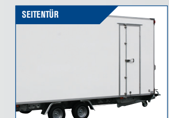
SEITENTÜR Drehstangenverschluss sorgt für dichten Verschluss.
