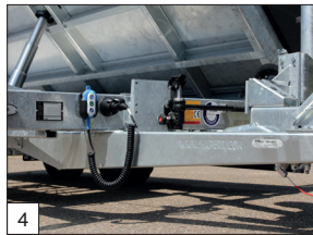
Serienausstattung: Abnehmbarer Bedienungskasten inkl. Spiralkabel und Nothandpumpe.
