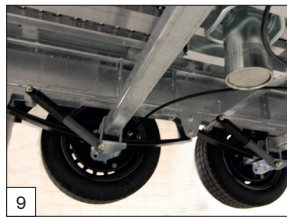
Serienausstattung: Parabelfederung inkl. Stoßdämpfer.
