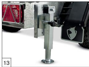
Serienausstattung: 2 schwere Kürbelstützen montiert inkl. Kurbel mit Halter.
