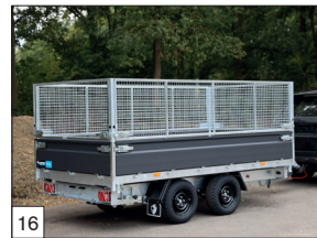
Option: Abnehmbarer und pendelbarer Gitter Aufsatz 75 cm hoch, inkl. Verschlüssen. Auch lieferbar bei Heckbordwand oben und unten scharnierend.
