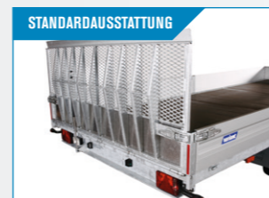
Kräftige Heckrampe mit Gasfeder. Robuste Verschlussbeschläge halten die Rampen fest.
