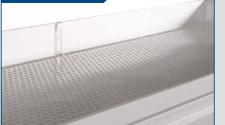
Robuster Alu-Dielenboden erhöht die Lebensdauer des Anhängers. Rutschfest.
