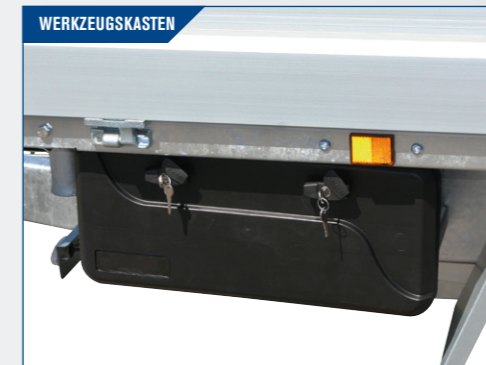
Robuster Kasten mit eingebautem Schloss. Für Montage unter der Ladefläche, 55 x 25 x 30 cm (L x B x H).
