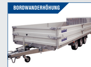
BORDWANDERHÖHUNG Erhöhen das Raumvolumen vom Anhänger. Klappbar und abnehmbar.
