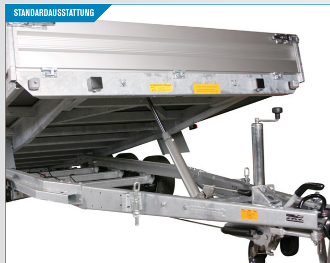
Kippvorrichtung mit kräftigem Stempel und manueller Handpumpe. Sicher und stabil.
