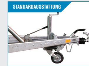
STANDARDAUSSTATTUNG Hydraulischer Kipp und Stützrad. Ladefläche wird mühelos hochgepumpt und fixiert.
