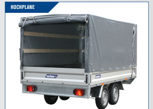
Kräftige Qualität, geschweißtes Gestell und querlaufende Aussteifung. Innenhöhe 210 cm wenn montiert.
