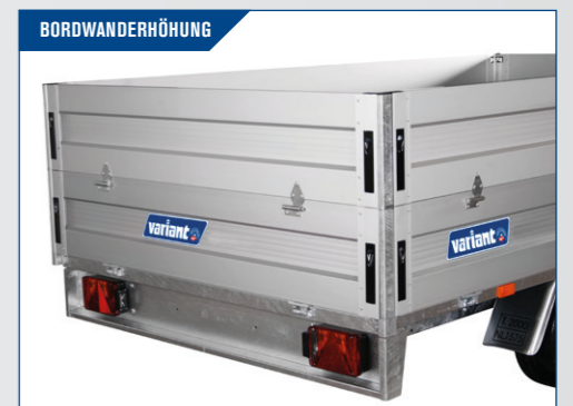
Erhöhen das Raumvolumen des Anhängers. Alle Bordwände sind mit Scharnieren und sind klapp- und abnehmbar. Feine und reinigungsfreundliche Innenseite, Höhe 35 cm.
