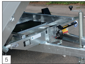
Option: Nothandpumpe bei Elektropumpe, montiert.
