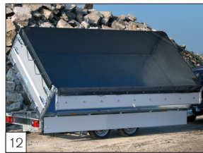
Option: Pendel-Aufsatzbordwände 40 cm hoch mit Ladungsnetz, engmaschig.
