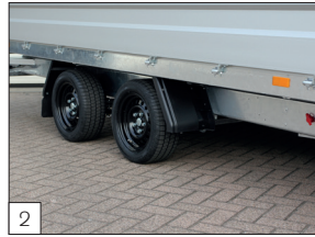
Serienausstattung: rundherum sind extra Scharnierpunkte inkl. Haken angebracht.
