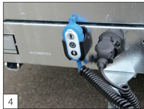
Serienausstattung: abnehmbarer Bedienungs-Kasten inkl. verlängertem Spiral-Kabel.
