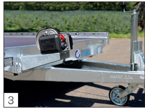
Serienausstattung: mit starker, verstellbarer Winde und Windenhalterung.
