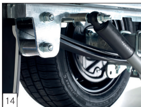
Option: Modelle in 3500 kg ZGG sind lieferbar mit Parabelfederung inkl. Stoßdämpfer (serienmäßig beim Modell in 505x221 cm).
