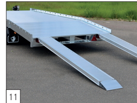
Serienausstattung: 2 Aluminium-Auffahrschienen ca. 250 cm.
