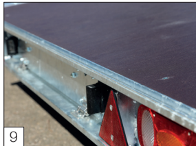
Serienausstattung: U-Profil an der Heckseite.
