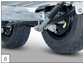
Option: Parabelfederung inklusive Stoßdämpfer.
