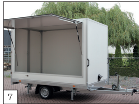
Option: Seitenklappe mit unterem Teil der Seitenwand fest und 4 Kurbelstützen montiert.
