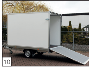
Option: Heckklappe mit grauer Anti-Rutsch-Beschichtung. Die Klappe ist mit Gasdruckfedern versehen.
