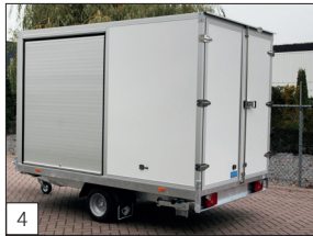
Option: Aluminium-Schiebelade (max. Größe 180 cm hoch x 150 cm breit) in der Seitenwand.
