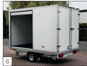
Option: Aluminium-Rolllade geöffnet (max. Größe 210 cm hoch x 150 cm breit) in der Seitenwand.
