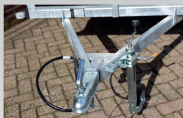
Verschraubte V-Deichsel 105 cm lang inkl. Abreißseil
