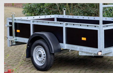
2 Bordwandseitenstützen pro Seite
